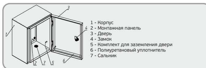
Корпус ЩМП является универсальной конструкцией и применяется для сборки разнообразных электрощитов: силовых, вводно-распределительных, управления и автоматизации технологических процессов, сигнализации. Щит может использоваться как на промышленных объектах, так и в общественных, жилых зданиях.
