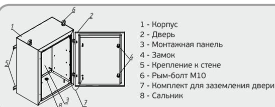
Корпус шкафа утепленного используется для размещения и защиты от низких температур электрооборудования, контрольно-измерительных приборов и автоматики (КИПиА) и компонентов автоматизированных систем управления, эксплуатируемых в неотапливаемых помещениях или на открытом воздухе при температуре от  $-50^{\circ}$  до  $+40^{\circ}$  С.
